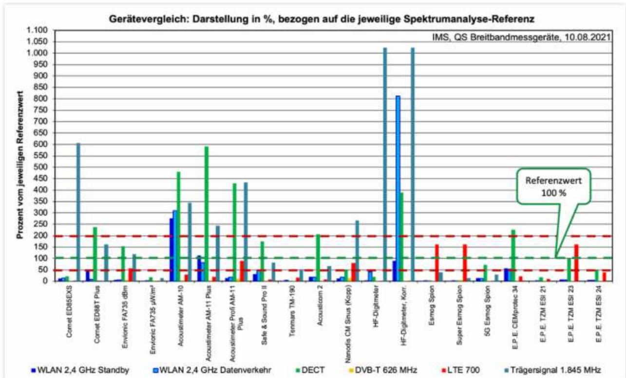
(1) Ergebnisse der Messungen, normiert auf die jeweiligen Referenzwerte der Spektrumanalyse, gesamter Auswertebereich bis 1.100 %. Die dunkelgrüne, gestrichelte horizontale Gerade entspricht dem Referenzwert (= 100 %), die beiden rot gestrichelten Linien zeigen das Toleranzband von +/-3dB (Faktor 2 bzw. 1/2, entsprechend 200 % bzw. 50 % des Referenzwertes)
